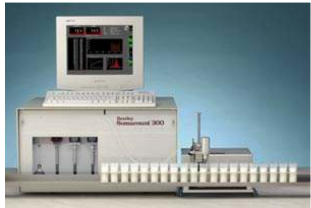
Şekil 2. Büyük ölçekli sayılar için geliştirilmiş bir SHS sayım cihazı
