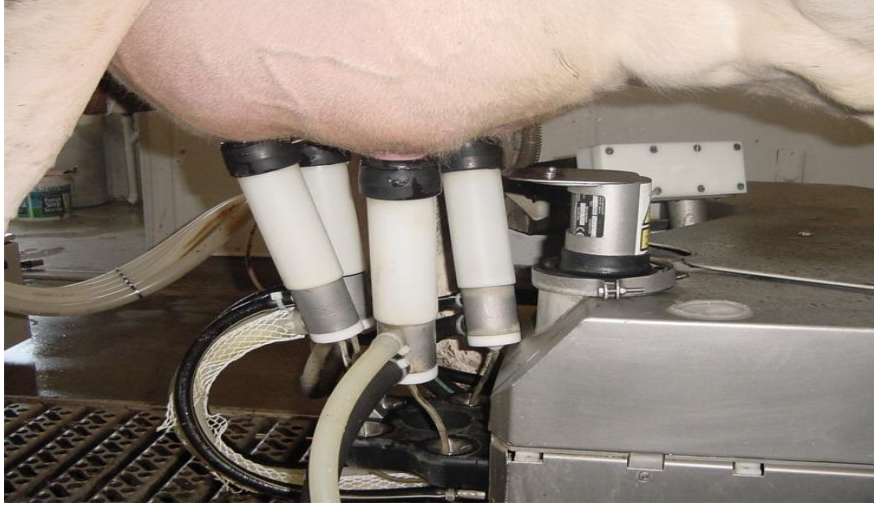
Şekil 2. Robotlu Sağım Sisteminde Sağım İşlemi ( http://www.uwex.edu/ )
