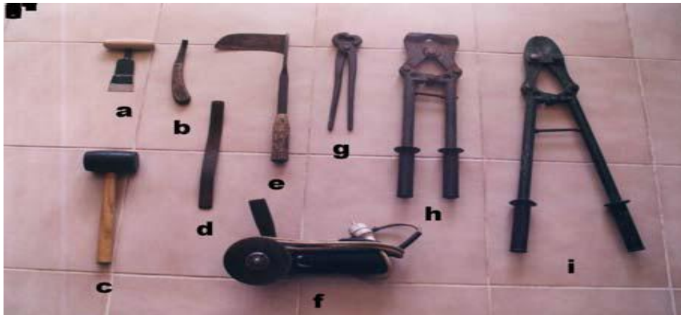
Resim 1. Tırnak kesiminde kullanılan bazı alet ve ekipmanlar; a)Tırnak keski, b) Tırnak bıçağı-renet, c) Tokmak, d) Törpü e) Suntraç, f) Avuç içi taşlama cihazı, g) Tırnak kerpeteni ,h ve i) Tırnak makası
